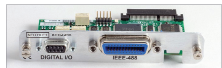
KTTI-GPIB GPIB 接口及 6 个 I/O 端口
